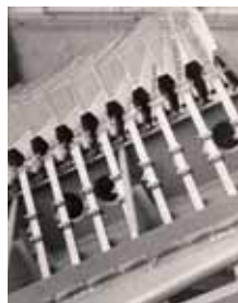
Рис. 8. Фрагмент многолучевой 24-х канальной антенны РЛС ПРО «ЦСО-С» с частотным сканированием ДН.
