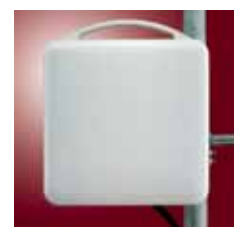
Радиооборудование со встроенной антенной (AIR) центральной станции
