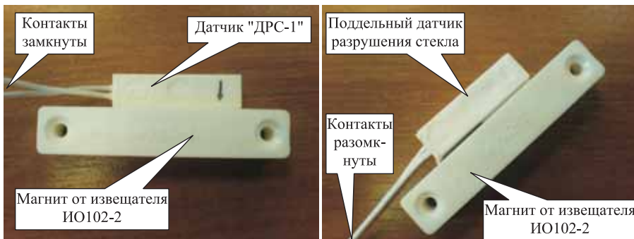
Рис. 5 Проверка датчиков разрушения стекла при помощи магнита
