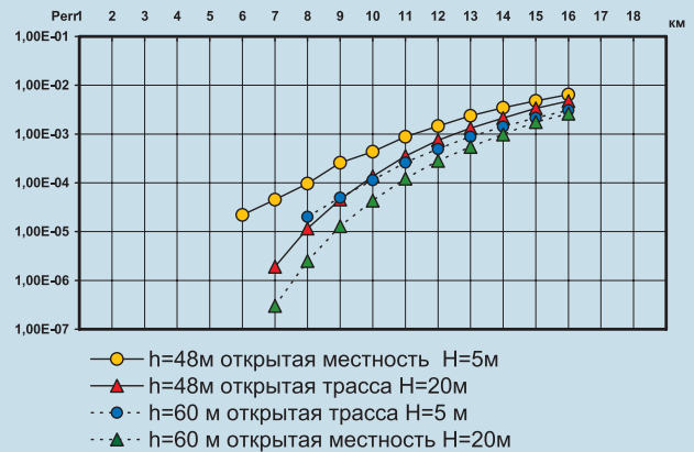
Рис. 2. Зависимость вероятности ошибки приема от высоты антенны базовой станции и степени закрытости местности.
