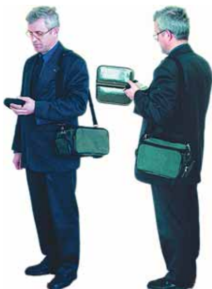
Рис. 8. АРК-НК3И в вариантах для открытого и скрытного пеленгования и автоматизированного радиомониторинга
