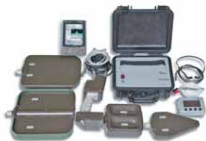
Рис. 7. Базовый комплект АРК-НК3И (9 кГц — 3 ГГц) с ЦРПУ «АРГА-МАК-И» в малогабаритном кейсе
