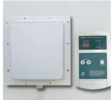
«Фон-3» и блок программирования для установки дальности его действия
