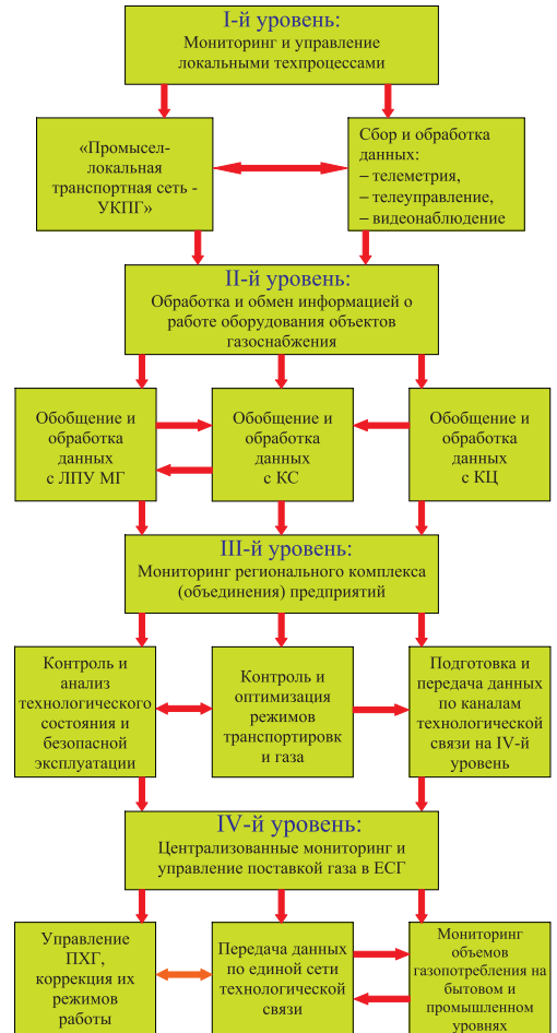
Уровни иерархии в системе мониторинга ЕСГ. Сокращения: УКПГ - установка комплексной подготовки газа, ЛПУ - линейное производственное управление, МГ - магистральный газопровод, КС - компрессорная станция, КЦ - компрессорный цех
