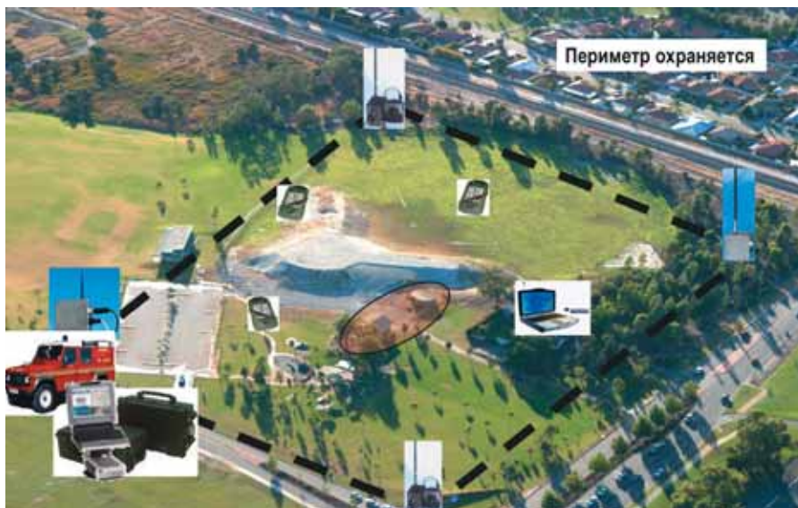
Рис. 1. Схема организации контроля и охраны периметра в зоне быстрого реагирования
