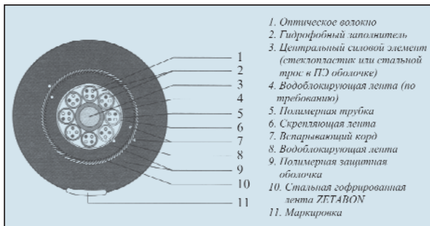
Рис. 3. Конструкция ОК для магистральных, внутризональных, городских линий связи марки ОКЛСт.
