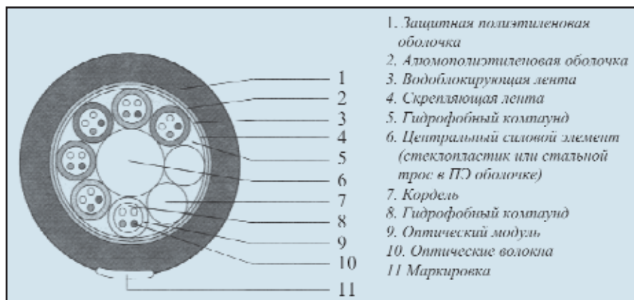
Рис. 2. Конструкция ОК для прокладки в трубах Dura-Line-методом.
