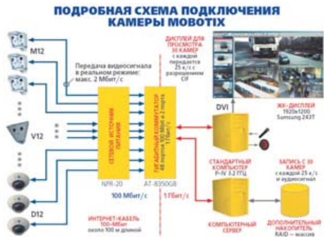
Рис. 6б. Подробная схема подключения камер Mobotix
