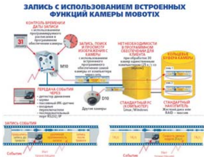
Рис. 6а. Запись с использованием встроенных функций камеры Mobotix
