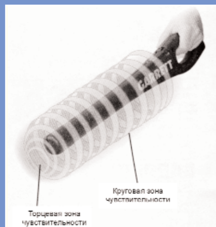
Рис. 2. Зона чувствительности металлодетектора GARRETT Super Wand
