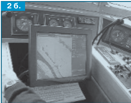
Рис. 2а и 2б. Прототип системы "АРГО" на катере MS Mainz, оснащенной электронной картой водных путей по стандарту Inland-ECDIS. Разработана Институтом системной динамики и техники управления Штутгартского университета.
