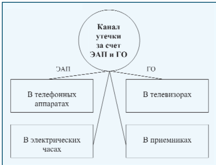
Рис. 4. Модель угроз за счет электроакустического преобразования и гетеродинного оборудования.
