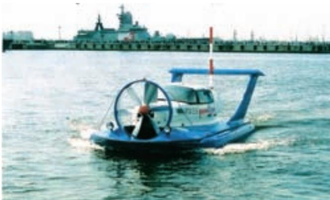
Приводная радиостанция, смонтированная на скоростном амфибийном судне на воздушной подушке, является мобильным радиотехническим комплексом многоцелевого назначения, способным эффективно работать в местах, где применение других видов транспорта затруднено. Таким образом, ПАР-2007 может быть оперативно доставлен в любую заданную точку и без предварительной установки и развёртывания осуществлять работу на привод летательных аппаратов.
