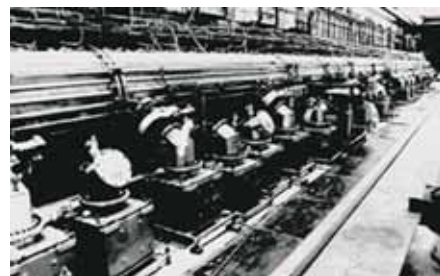
Ускоряющие резонаторы второй части ускорителя «Мезонная фабрика». Длина резонаторов — 400 м
