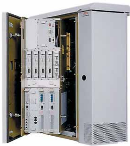
Рис. 6. Малогабаритная базовая станция в настенном исполнении
