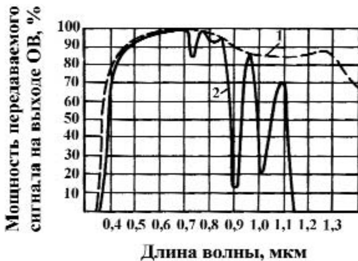
Рис. 2. Зависимость мощности передаваемого сигнала на выходе ОВ от длины волны. 1 - кварцевое ОВ; 2 - ПОВ
