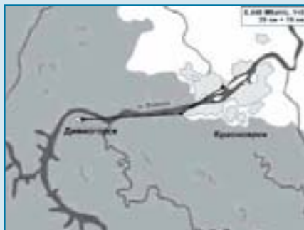
Рис. 1. РРЛ "Красноярск-Дивногорск" 8 Мбит/с (Е2), 25+15 км
