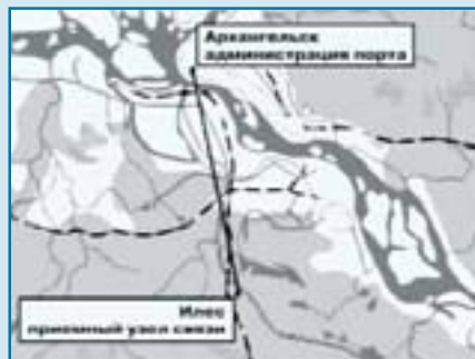
Рис. 2. РРЛ № 4722 "Архангельск, администрация порта - пос. Илес" 2 Мбит/с (Е1), 36 км, резервирование 2+0
