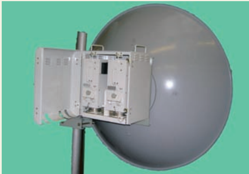
Антенный пост с двумя приёмо-передатчиками в защитном кожухе – контейнере
