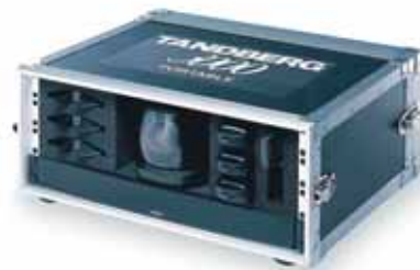
Рис. 1. Tandberg Model 6000 MXP Portable, базовая модель, 384 kbps ISDN/Ext.Netw./1.5 Mbps IP.
