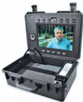
Рис. 2. Tandberg Tactical MXP, 15,4" LCD, до 4 видео и 3 аудио одновременных подключений, поддержка протоколов H.264, H.323, H.320 & SIP, возможность защищенного подключения, до 2 Mbps H.323 / 2 Mbps SIP / 512 kbps ISDN / 384 kbps V.35 / 2.3 Mbps.
